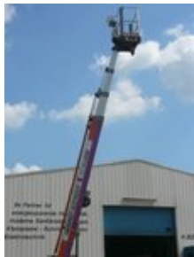
Hubarbeitsbühne ausfahrbar bis 22 mtr, drehbar 360°
